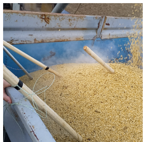
Les sondes de températures ont montré que lors d'une reprise en benne en sortie du toasteur mobile, le coeur du tas refroidit beaucoup moins vite, il y a un risque de surcuisson d'une partie des graines. Crédit : Idele
