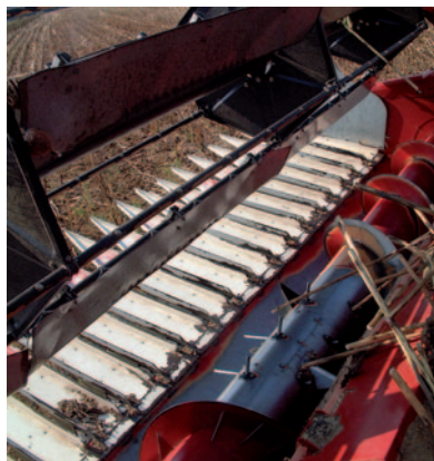
Barre de coupe équipée pour récolter le tournesol.
