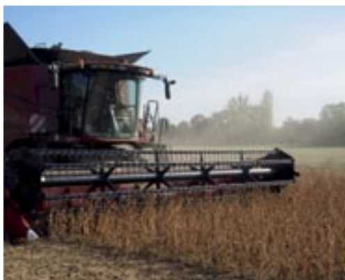
Une difficulté de la récolte du soja consiste à ramasser les gousses des étages inférieurs.
