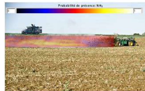
Figure 5 : Illustration de la télédétection par infrarouge lors d'un épandage de fumier © CNRS
