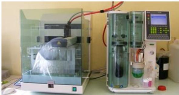
Appareillage de distillation et dosage selon la méthode Kjeldhal pour l'APM
