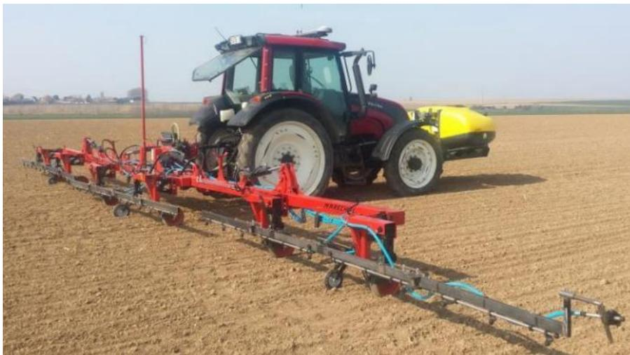
Les bandes pulvérisées peuvent mesurer 18 ou 25 cm de large, ce qui permet d'envisager une réduction des herbicides de 60 à 45%. La hauteur de pulvérisation étant plus basse qu'une pulvérisation en plein avec une rampe classique, la sensibilité au vent est inférieure et donc les fenêtres d'intervention sont plus fréquentes.
