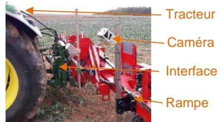
Ce type de guidage a été testé durant les campagnes d'essais 2018-2019 et 2019-2020 et s'est avéré satisfaisant : la caméra détectait bien les rangs (dans la mesure où ceux-ci sont visibles et bien distincts du sol nu de l'inter-rang) et l'interface corrigeait bien la position de la rampe selon ce que « voyait » la caméra. Le système s'adapte donc bien aux irrégularités du terrain mais il faut que les rangs de la culture soient bien visibles.
