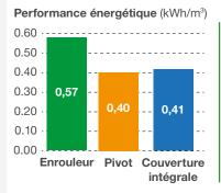
Figure 1: puissance électrique consommée par m³ d'eau délivré attendue pour trois types de matériel d'irrigation. Moyennes issues du suivi de 42 installations de 2012 à 2015, dans le cadre du projet EDEN.
