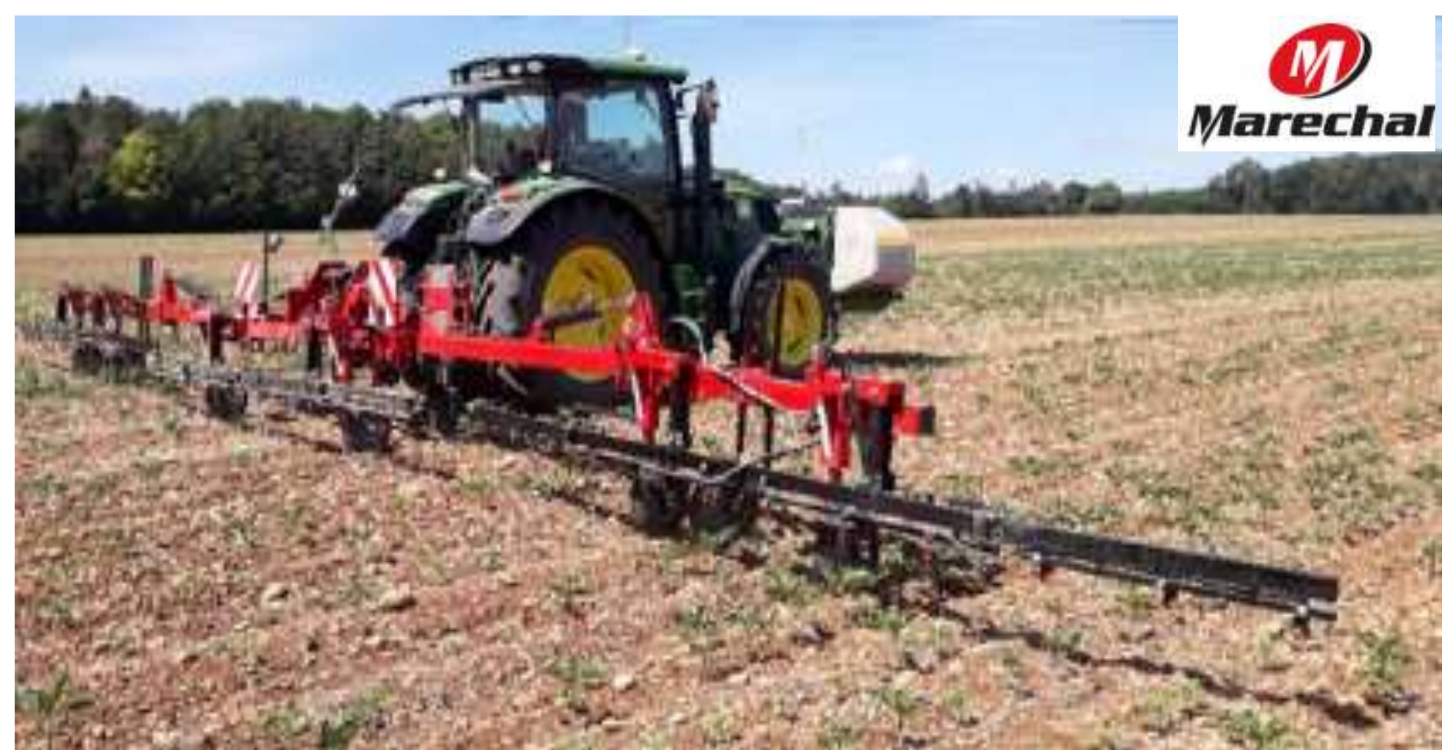
Rampe de pulvérisation localisée sur le rang
