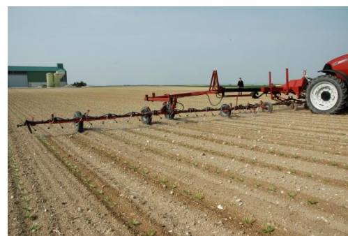
Rampe de traitement localisé (©ITB)
