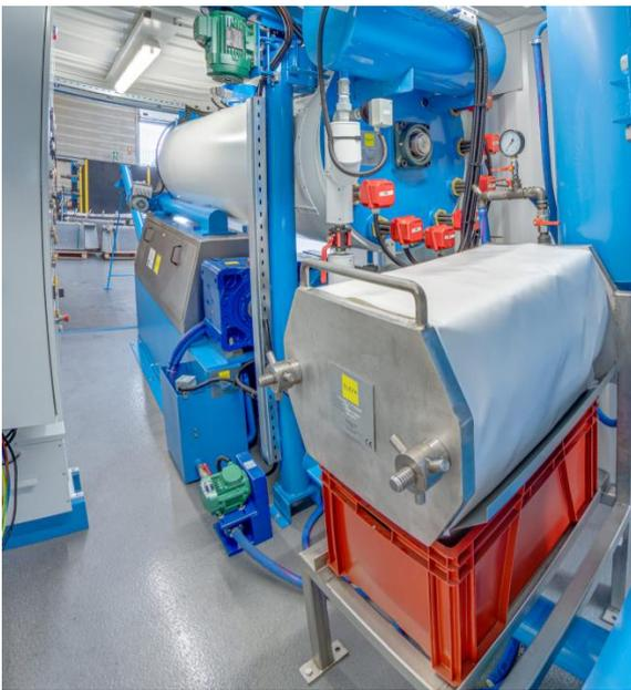
Cette unité permet à la fois la cuisson et le déshuilage. Elle comprend un concasseur (aussi appelé décortiqueur). Il s'agit d'un tambour rotatif équipé de couteaux tournant contre un stator également muni de couteaux. La matière est cisailée en passant dans l'appareil. La taille des particules peut être réglée en ajustant la distance entre les couteaux.
