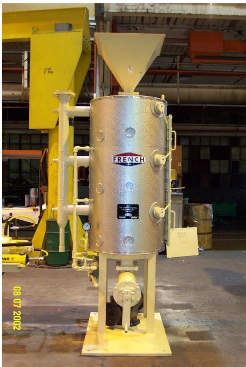
Le constructeur Américain de matériel d'huilerie propose un petit cuiseur de « laboratoire » fonctionnant à la vapeur qui dispose de 4 étages et permet d'alimenter une presse d'environ 250 kg/h de capacité. L'appareil nécessite un concassage en amont et un générateur de vapeur.
