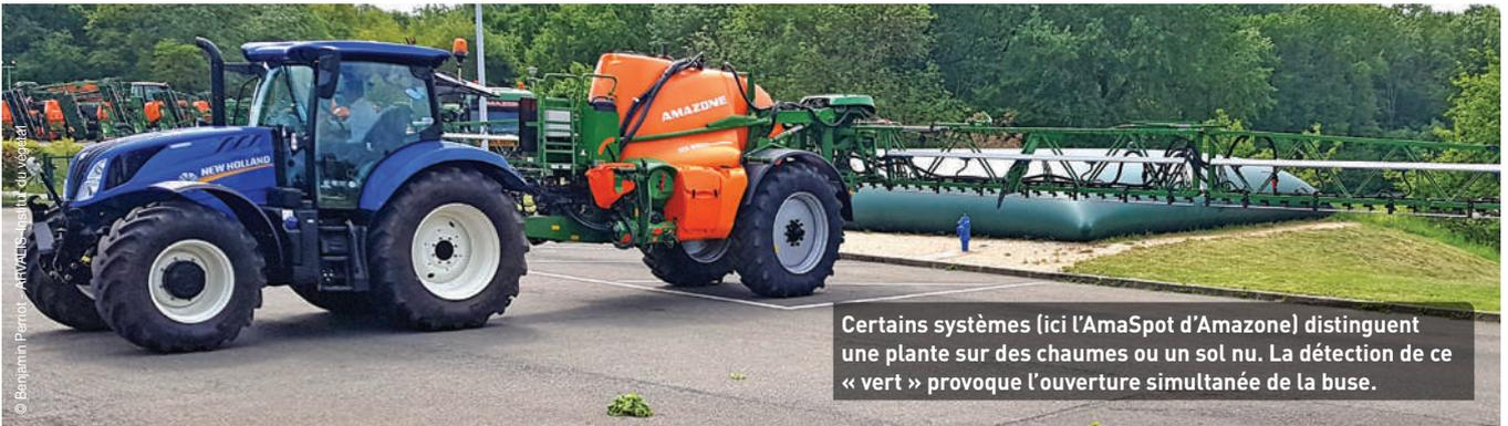
Certains systèmes (ici l'AmaSpot d'Amazone) distinguent une plante sur des chaumes ou un sol nu. La détection de ce « vert » provoque l'ouverture simultanée de la buse.
