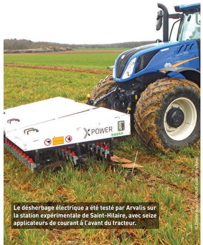
Le désherbage électrique a été testé par Arvalis sur la station expérimentale de Saint-Hilaire, avec seize applicateurs de courant à l'avant du tracteur.
