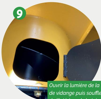
Ouvrir la lumière de la vis de vidange puis souffler de l'intérieur de la trémie.
