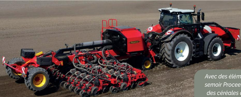
Avec des éléments repartis sur deux poutres, le semoir Proceed pourra, par exemple, planter des céréales à paille en 25 cm, des betteraves, colza et tournesol en 50 cm et du maïs en 75 cm.
