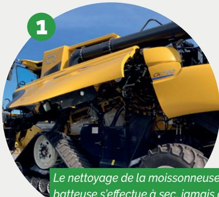
Le nettoyage de la moissonneuse-batteuse s'effectue à sec, jamais à l'eau, toujours de l'avant vers l'arrière de la machine, et de haut en bas.
