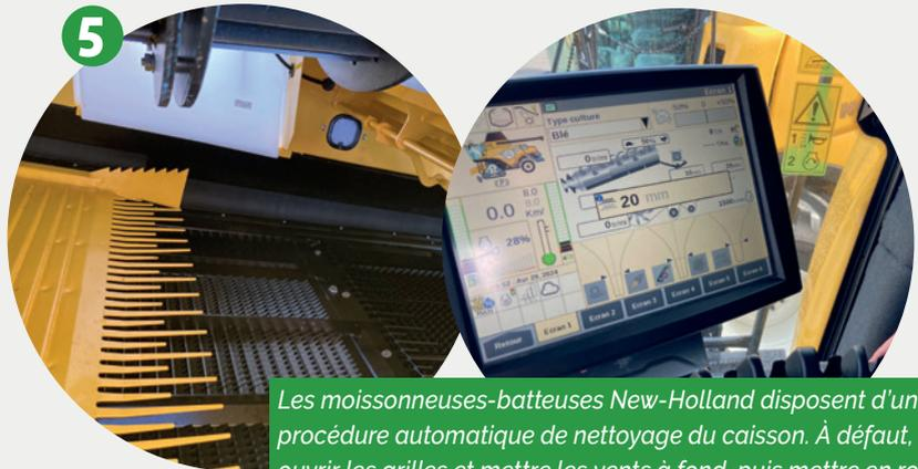
5 Les moissonneuses-batteuses New-Holland disposent d'une procédure automatique de nettoyage du caisson. À défaut, ouvrir les grilles et mettre les vents à fond, puis mettre en route.
