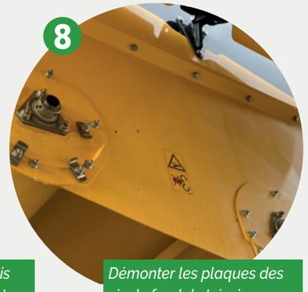
8 Démontez les plaques des vis de fond de trémie pour y souffler les grains restants.
