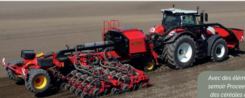
Avec des éléments repartis sur deux poutres, le semoir Proceed pourra, par exemple, implanter des céréales à paille en 25 cm, des betteraves, colza et tournesol en 50 cm et du maïs en 75 cm.
