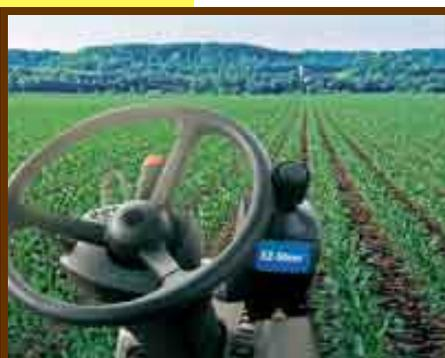
**Guidage par GPS (RTK)** : installé sur le système de guidage du tracteur, le GPS va permettre de diriger la bineuse avec une grande précision (plus ou moins 5 cm)
