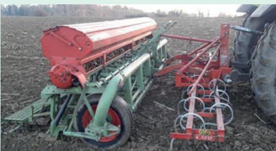
**Semoir à céréales NODET 4 m sans rotative (combiné à un vibro).**
