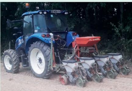
"Le semis du colza a été réalisé avec un semoir mono-graine à 75cm d'écartement".
