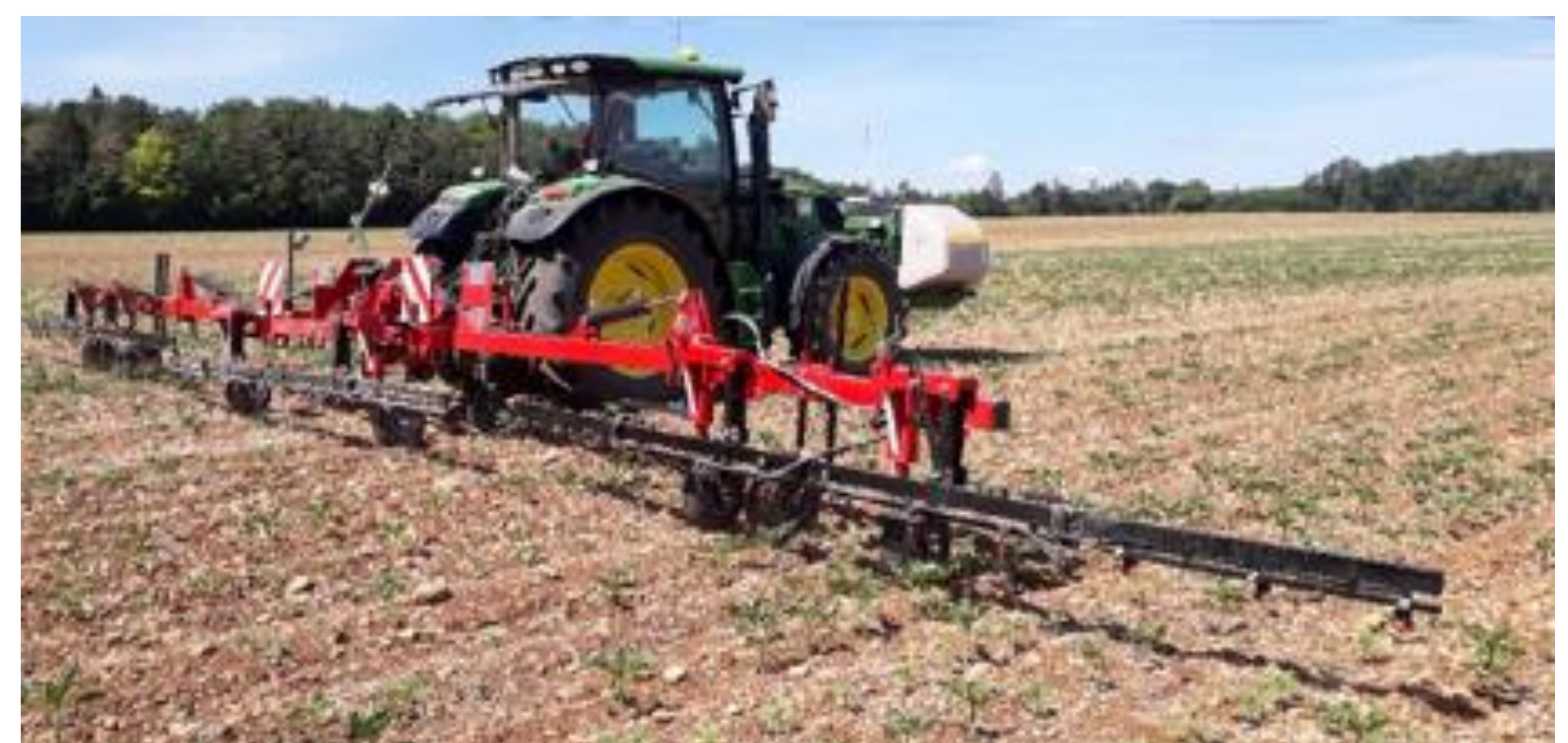
Rampe de pulvérisation localisée sur le rang
