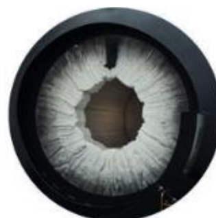
► Figure 9 : intérieur du tambour où se produit le toastage
