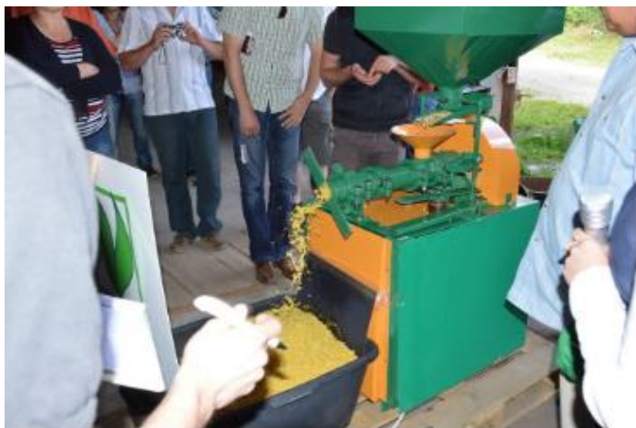
► Figure 25 : extrudeur Eurosivo (© Theresa Langer)
