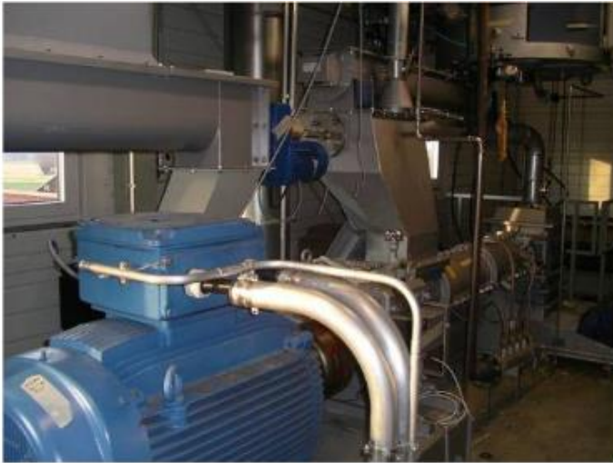
► Figure 10 : photographie de l'expander (© Ludwig Asam)
