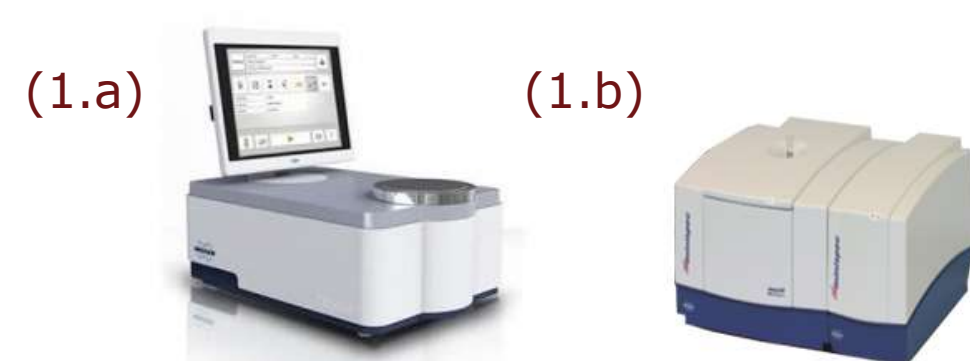
1. Instruments utilisés pour les scans : (1.a) Bruker TANGO pour les mesures NIRS et (1.b) Bruker minispec mq10 pour les mesures RMN
