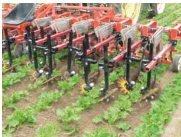
↳ Bineuse équipée de moulinets dans les betteraves
