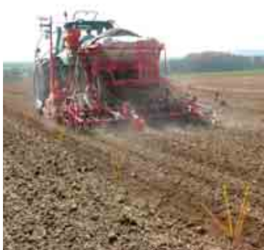
Le semis du chanvre est réalisé avec un semoir à céréales en ligne.
