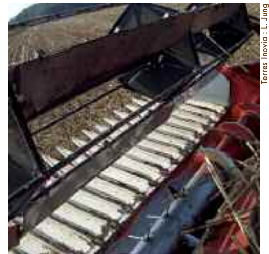
Barre de coupe équipée pour récolter le tournesol.
